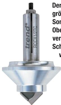
Der Gravurfräser ist in zwei Schaftgrößen (8 und 12 mm) erhältlich. Somit kann er für entsprechende Oberfräsen bzw. Spannzangen verwendet werden. Muss die HSS-Schneide einmal nachgeschärft werden, kann man den konische Anlaufring hierfür entfernen. Die Schneide ist in der Höhe nachjustierbar.
