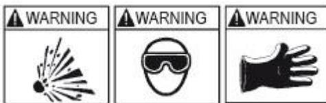
**RISK OF CONTACT WITH BATTERY ACID. BATTERY ACID IS A HIGHLY CORROSIVE SULFURIC ACID.**
